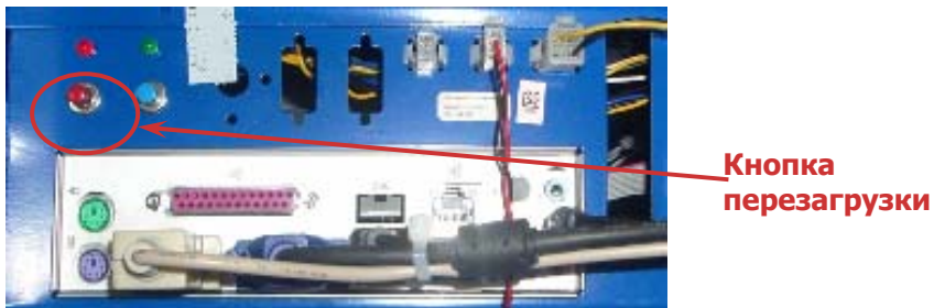
Рис. 15. Нажать кнопку перезагрузки компьютера
