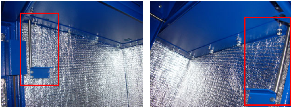
Рис. 6. Открыть компьютерный отсек с помощью рычагов
