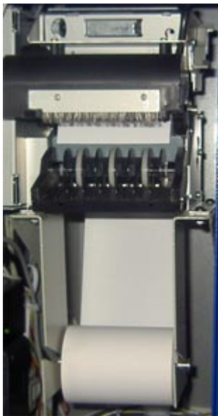
Рис. 14. Внешний вид принтера Citizen PPU-700
