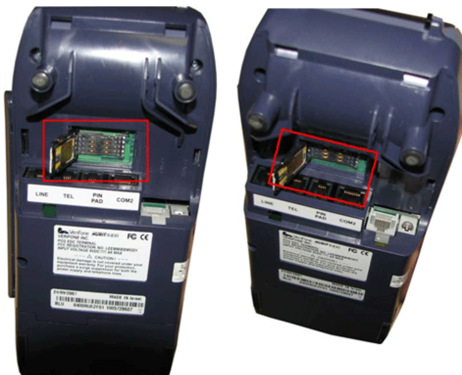
Рис. 3. Расположение разъема для сим-карт в терминалах Nurit 8400
